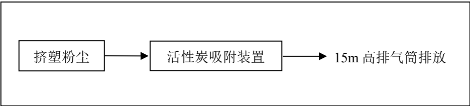
图 3-2 挤塑废气处理工艺流程图
